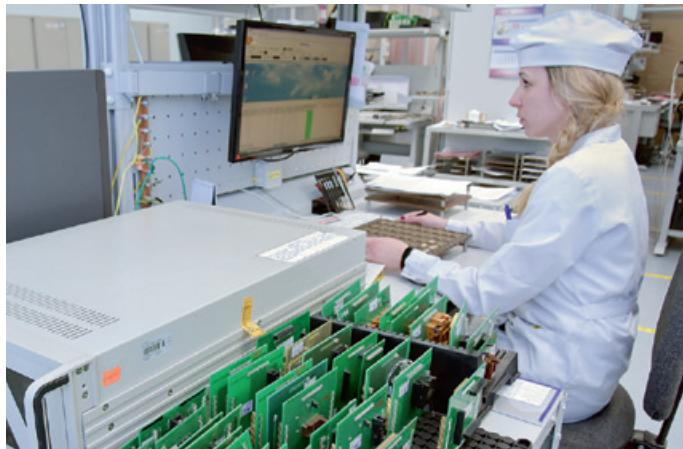
**6. Измерение электрических параметров аналоговых ИС, аналого-цифровых ИС: ЦАП-АЦП, компараторы, синтезаторы частоты, операционные усилители и т. д.**
