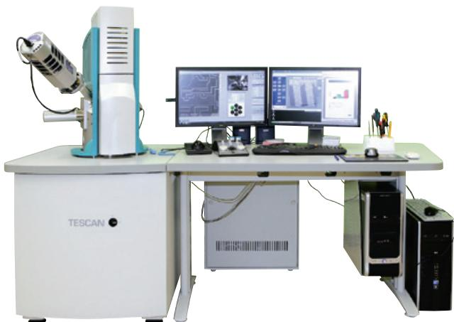
Растровый электронный микроскоп VEGA 3 LMH с системой рентгеноспектрального микроанализа INCA Energy 250 X-max
