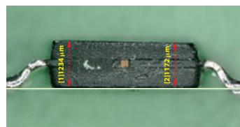
Измерение толщины корпуса микросхемы. На корпусе отсутствует фаска, микросхема имеет различную толщину. Последствия механической обработки корпуса.
