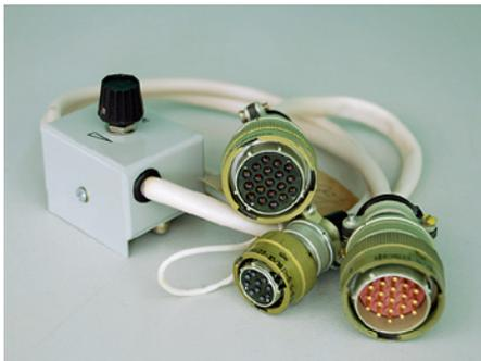
Испытательный кабель с радиоэлементами
